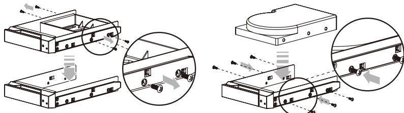
ステップ5 完了したら、ドライブトレイをドライブに戻し、ラッチをはめます。
