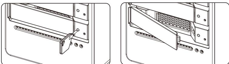
Schritt 4 Entfernen Sie den Laufwerksstabilisator vom Wechselrahmen. Montieren Sie die Festplatte auf dem Wechselrahmen und sichern Sie sie mit den Schrauben aus dem Zubehörset.
