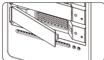
ステップ4 リムーバブルトレイからドライブスタビライザーを取り出します。使用するハード ドライブをトレイに装着し、アクセサリー キット付属のねじで固定します。
