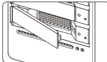
Etape4 Enlevez le stabilisateur de disque du plateau amovible. Monter le disque dur sur le plateau et vissez les vis fournies dans le kit d'accessoires.
