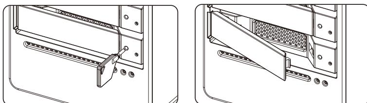
Paso 4 Extraiga el estabilizador de disco de la bandeja extraíble. Instale el disco duro en la bandeja y asegúrelo con los tornillos suministrados en el kit de accesorios.
