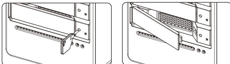
步驟4 將硬碟安裝到抽取盒上,並以零件包內附的螺絲加以固定,以避免不必要的移動對硬碟造成傷害。
