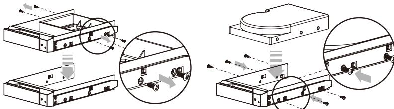
Schritt 5 Legen Sie das Laufwerk nach Abschluss wieder zurück in die Laufwerksposition und schließen Sie den Hebel.
